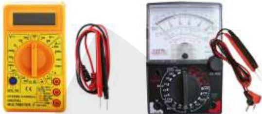
Multímetro digital OU analógico
